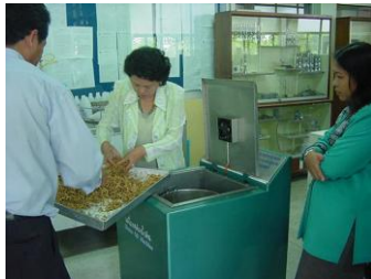
ภาพที่ 2 กระบวนการสลัดน้ำมันโดยใช้เครื่องสลัดน้ำมันสำหรับผลิตภัณฑ์อาหารประเภททอด
